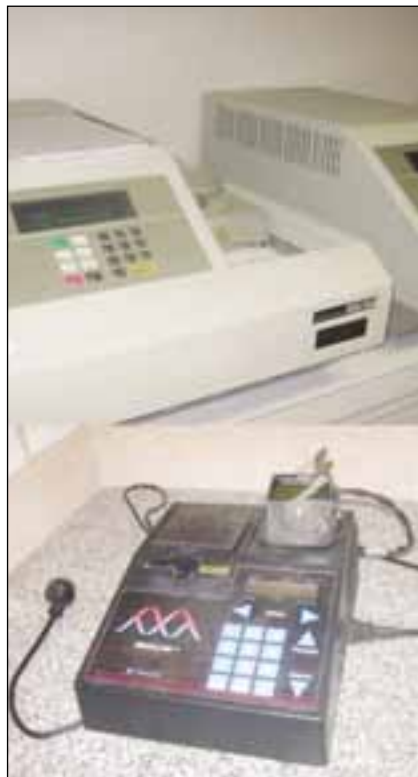
Area de amplificación por PCR: se cuenta con dos equipos Perkin Elmer 9600, (arriba) con capacidad para procesar hasta 96 muestras simultáneas cada uno, y un equipo MJ Research (abajo) para 25 muestras.
