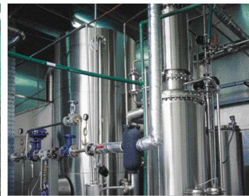
Termodestilador de agua para inyectables calidad USP.
